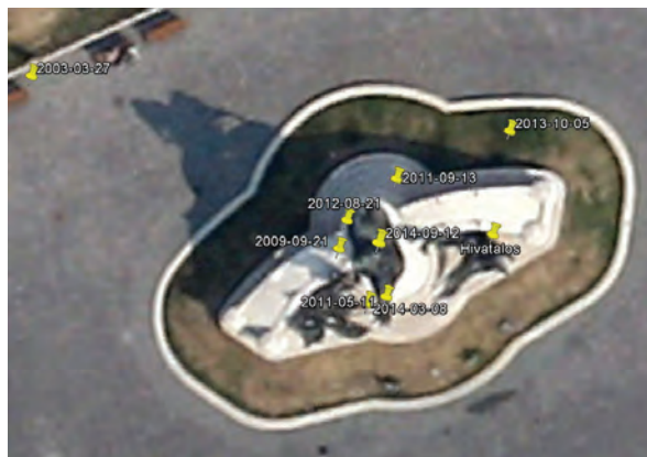
■ 5. kép. A Mátyás-szoborcsoport közepének helyzete a Google Föld különböző időpontú légifényképein és a román hivatalos (ANCPI) ortofotón
